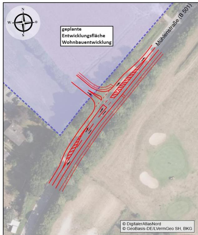
Bild 7.1: Konzeptskizze des Erschließungsknotenpunktes an der B 501
