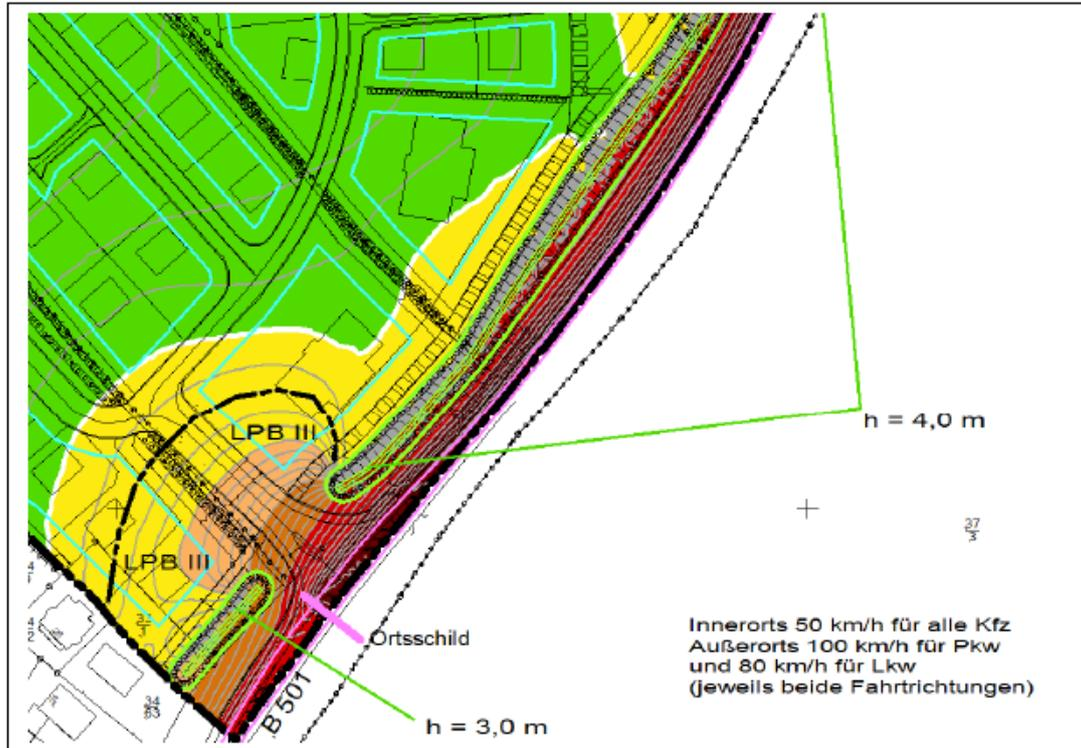
Abb.: Anforderungen an den passiven Schallschutz im EG, Quelle: „Gutachten Nr. 21-07-2 - Verkehrslärmuntersuchung zur Aufstellung des Bebauungsplanes Nr. 89.1 der Gemeinde Grömitz für die Erweiterung der Wohngebietes Beckerkoppel“, Ingenieurbüro für Schallschutz, Dipl.-Ing. Volker Ziegler, Möln, Stand: 10.08.2021, S.21.
